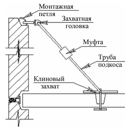
Рис. 24. Установка наружных панелей
