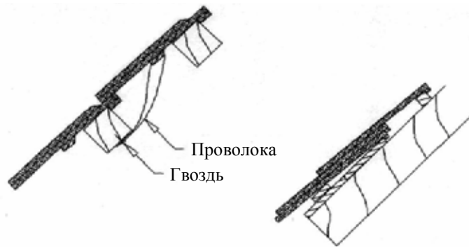
Рис. 45. Устройство черепичной кровли
